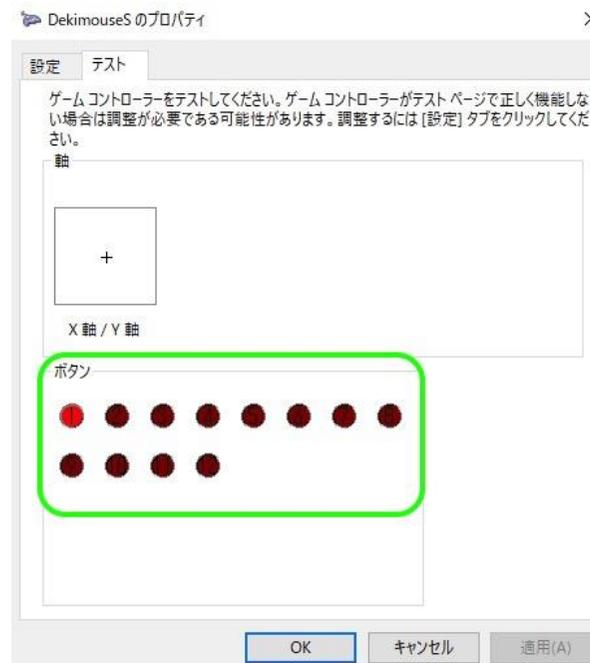
もし、赤く表示しない場合は、接続スイッチの挿入を確認します。それでも機能しない場合は、手順2に戻り、デバイスの削除を行い、あらためて手順1から操作します。
