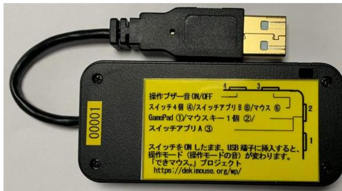
スイッチ接続部には、4個までのスイッチを接続することができます。また、このジャックに挿入したスイッチを ON のまま USB に接続しますと、操作モードや操作ブザー音の設定ができます。
