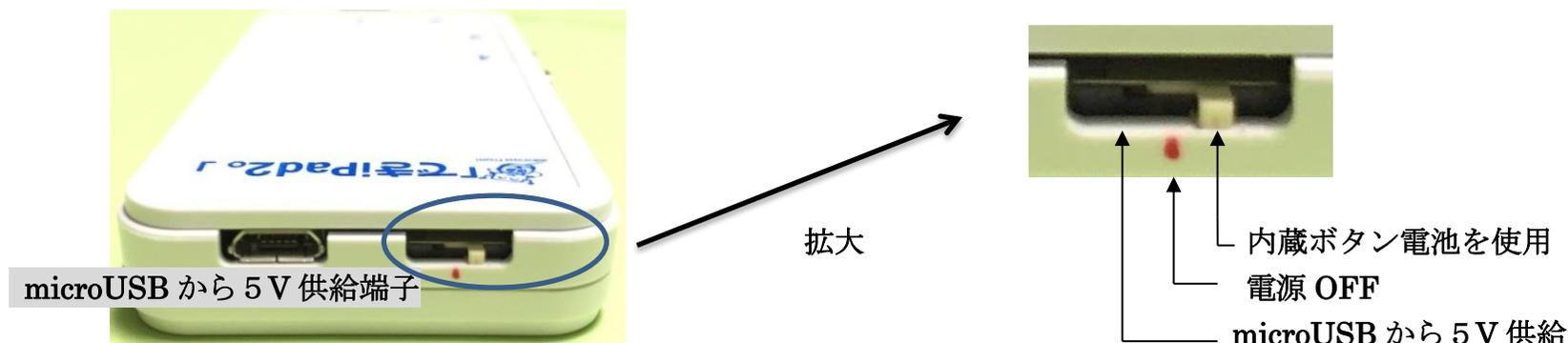
5VDC (USB-microUSB 変換ケーブルで iOS 製品の AC アダプタなどから供給します。電池は、ボタン電池 CR2032 を使います。(AC アダプタをご利用の際はボタン電池を外してください。) モバイルバッテリーはオートパワーオフモード非搭載をご利用ください。 [https://www.amazon.co.jp/dp/B018KD0D82/ref=cm\\_sw\\_em\\_r\\_mt\\_dp\\_U\\_I07ZEb17WTTFB](https://www.amazon.co.jp/dp/B018KD0D82/ref=cm_sw_em_r_mt_dp_U_I07ZEb17WTTFB)
